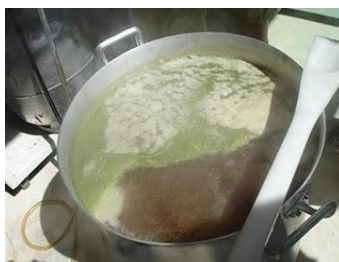
Figura 4 – Ebulição do mosto e adição do lúpulo.
