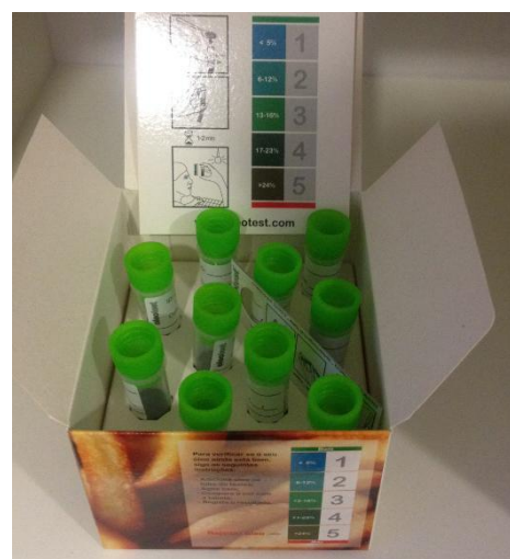
Figura 9. OleoTest e respetiva tabela cromática (Cor 4 (17-23%), valores de compostos polares próximos da ilegalidade; cor 5, valores de compostos polares que determinam a rejeição do óleo)
